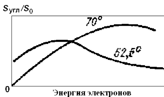
Рис. 15.3. Влияние угла падения электронов на энергетическую зависимость оптической плотности фотографической плёнки: s_0 — оптическая плотность при нормальном падении
