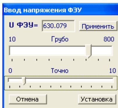
С помощью ползунков можно установить требуемое напряжение на ФЭУ. Нажав на кнопку **Применить** можно передать изменяемые данные в электронный блок и посмотреть правильность выбора напряжения ФЭУ.
