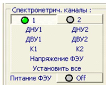
Если вы впервые приступаете к работе, то установите нижний **ДНУ1** и верхний **ДВУ1** уровни дискриминатора, *коэффициент усиления К1*, *напряжение ФЭУ* и включите **Питание ФЭУ** (кнопка  off), нажмите кнопку **Установить все**.
