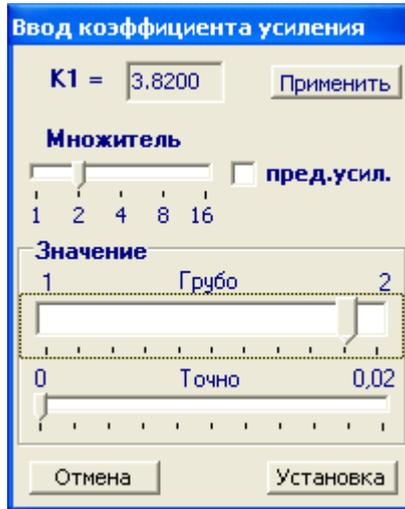
С помощью ползунков можно установить требуемый коэффициент усиления. Величина коэффициента усиления равна произведению множителя на значение. Нажав на кнопку **Применить** можно передать изменяемые данные в электронный блок и посмотреть правильность выбора коэффициента усиления.
