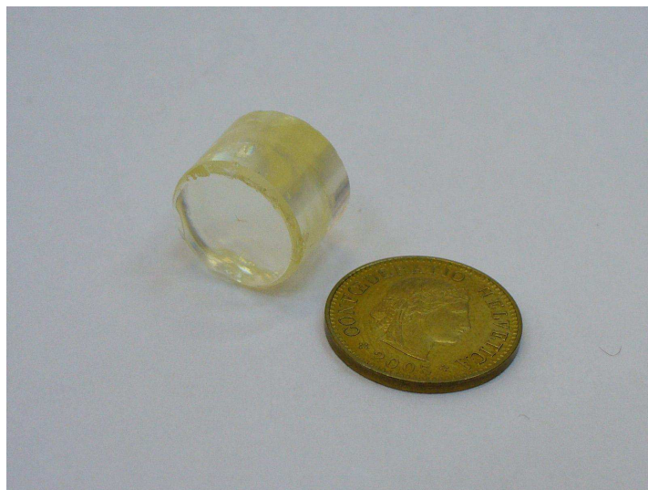
Рис. 1. Первый сцинтилляционный кристалл вольфрамата свинца
