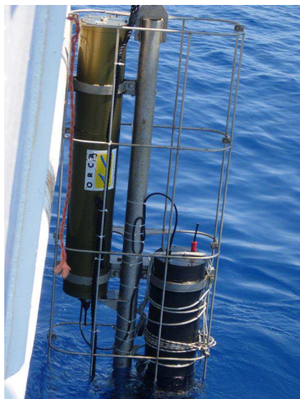
Рис. 5. Извлечение спектрометра после глубоководной долговременной миссии
