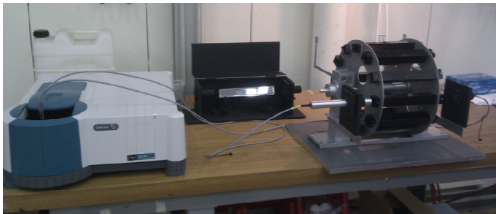
Рисунок 1.17. – Фото стенда для дистанционного измерения оптического пропускания кристаллов PWO после облучения протонами
