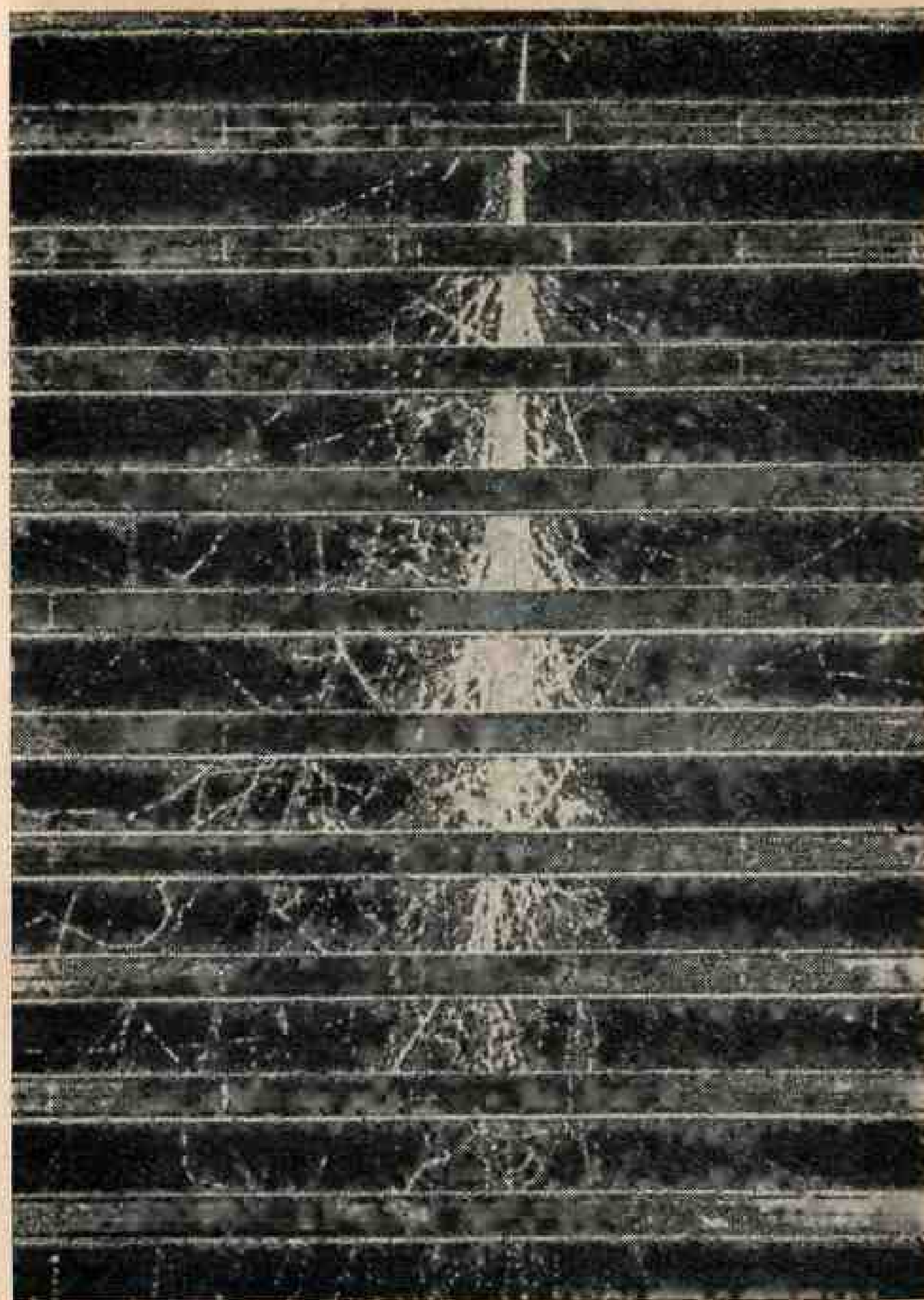
Рис. 43. Фотография развития ливня в ряде латунных пластин толщиной 1,25 см, расположенных в камере Вильсона. Ливень создан в верхней пластине электроном высокой энергии или фотоном. Фотография получена группой по изучению космических лучей в Массачусетском технологическом институте.
